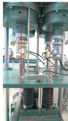
图12 法向位移传感器的固定装置
