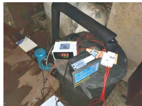
图 3 恒温热响应测试平台
