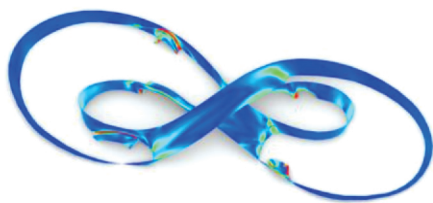
图8 一层立面+吊顶层表皮曲率分布
