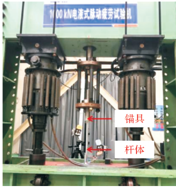
图6 碳-玻璃纤维混杂杆体拉-拉疲劳测试
