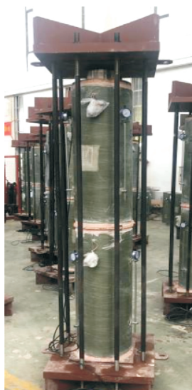
图2 持载及加载装置图.
