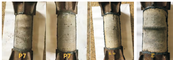
图6 混合混凝土破坏图
