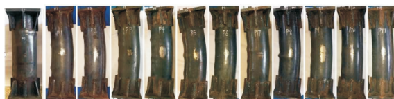
图5 偏压试件变形图
