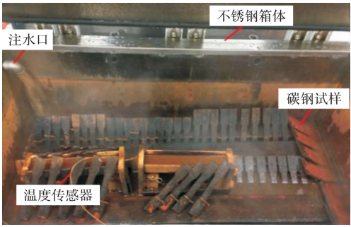
图 2 周浸试验箱内部
