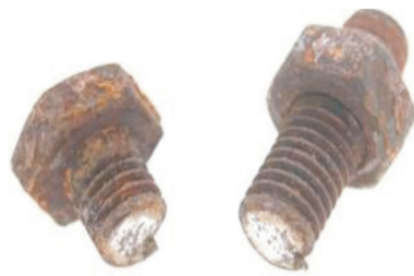
图 18 腐蚀后的螺栓连接断口形貌
