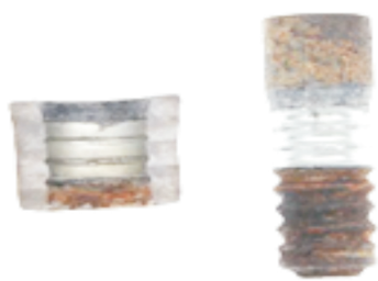
图 19 腐蚀后的拉铆钉铆杆和套环
