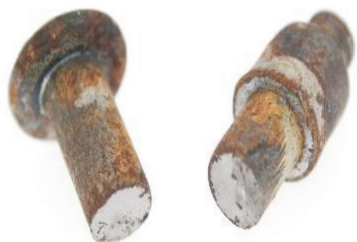
图 20 腐蚀后的拉铆连接断口形貌
