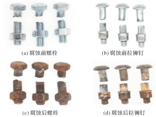
图8 螺栓和铆钉的破坏形态图
