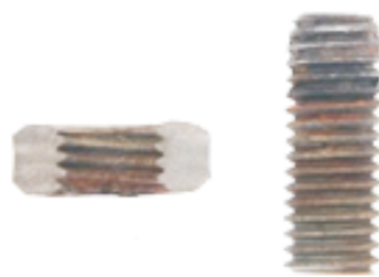
图 17 腐蚀后的螺栓螺杆及螺帽
