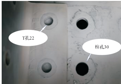
图 3 T 型件翼缘和柱壁开孔实图
