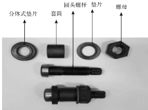
图 2 嵌套式单边螺栓组成
