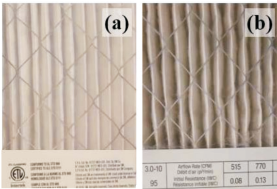
图 4 未使用过的滤料 #3(a)和真实环境中使用过的滤料 #3(b)的实物图
