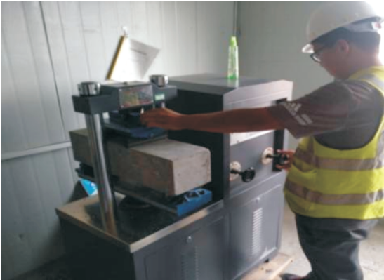
图 3 水泥混凝土抗折试验 Fig. 3 Flexural test of cement concrete
