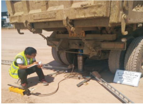
图 4 地基反应模量试验 Fig. 4 Test of subgrade reaction modulus
