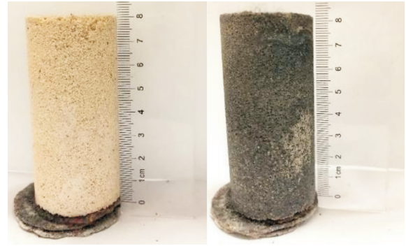
图 4 经 MICP 处理加固后的砂柱
