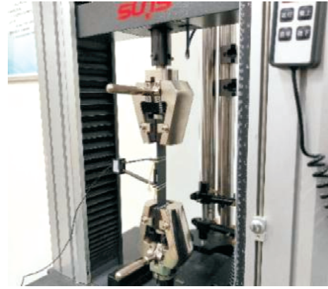
图 7 拉伸试验过程
