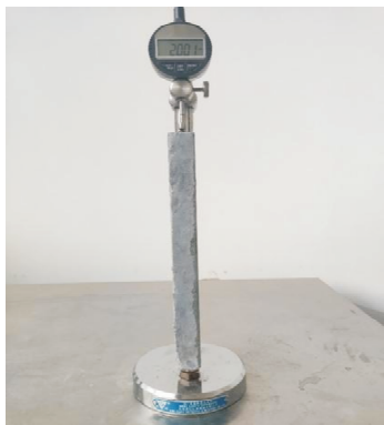
图 3 比长仪和千分表 Fig. 3 Comparator and dial indicator
