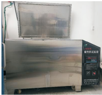
图 2 JKS 型碱骨料试验箱 Fig. 2 JKS type alkali aggregate test chamber
