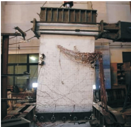
图 10 试件破坏情况 Fig. 10 Failure of specimen
