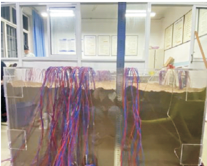
图 6 填土完成 Fig. 6 Filling completed
