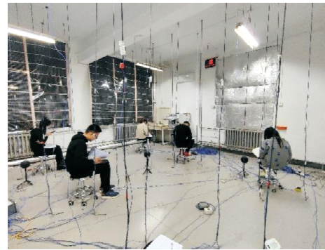
图 6 局部辐射供暖实验
