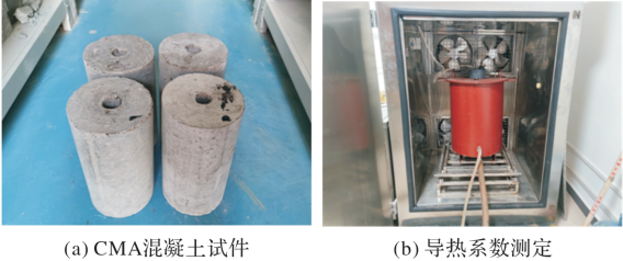
图 1 CMA 混凝土导热系数试验 Fig. 1 Thermal conductivity test of CMA concrete
