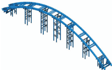
图 4 钢管拱拼装完成后模型
