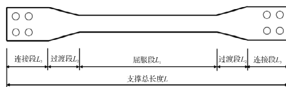
图2 屈曲约束支撑各段长度
