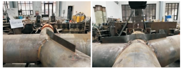
图 8 试件 TY-2 破坏形态
