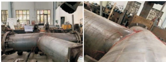
图 7 试件 TY-1 破坏形态
