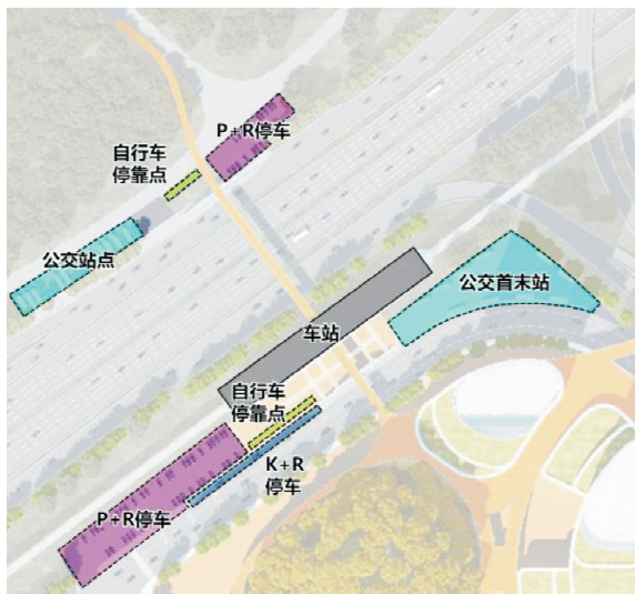
图9 无缝换乘接驳设施布局图
