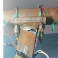
右侧钢管顶部端板处断裂
