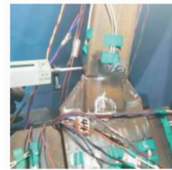
左侧钢管加劲肋处断裂
