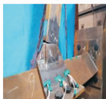
右侧钢管加劲肋处断裂
