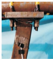
右侧钢管顶部端板处断裂
