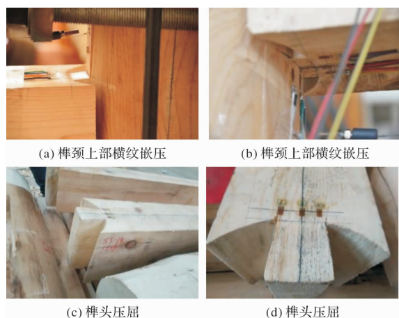
图8 节点模型 SJ-18 破坏状态
