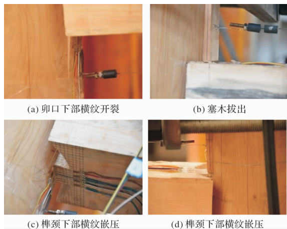
图7 节点模型 SJ-17 破坏状态
