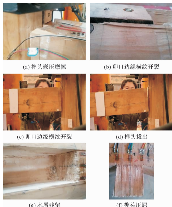
图9 节点模型 SJ-19 破坏状态
